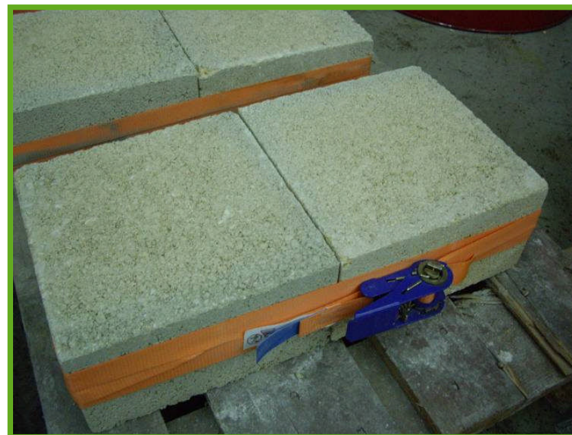
Soporte para ensayo de fatiga según EOTA TR 008
